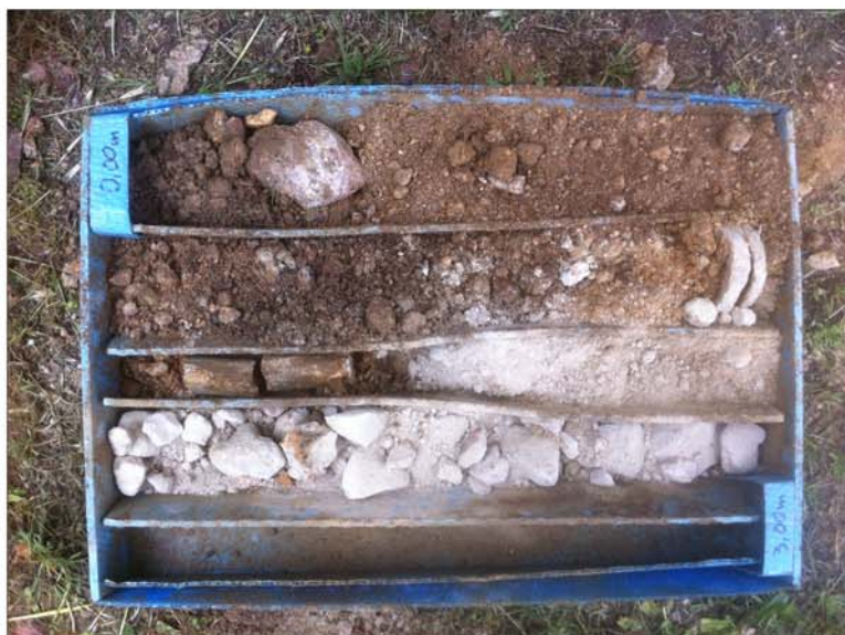
Foto 9: Material perforat entre 0 m i 3 m a S2.
